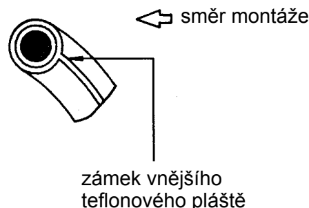
Obr. 8: Zámek vnějšího pláště směřuje proti směru montáže.
